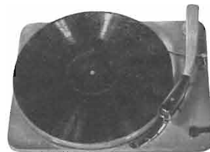
Fig. 13 Questo è il giradischi semiprofessionale della società svizzera Lenco. Esso costituisce indubbiamente un buon compromesso pratico realizzando le qualità prescritte dall'alta fedeltà con un costo relativamente moderato. Mediante un ruotismo speciale brevettato è possibile ottenere con la massima facilità qualsiasi velocità tra i 16 ed i 78 giri. Un braccio metallico comandato dalla leva di arresto permette inoltre il sollevamento semiautomatico della puntina dal solco all'atto che si interrompe il circuito elettrico del motore.
